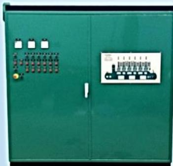
Panel de mandos centralizado con acceso independiente para cada uno de los cabezales. Equipado con mando manual de subida y bajada del cabezal. Amperímetro para medición del consumo de los motores. Regulador y manómetro indicador de la presión de trabajo.
